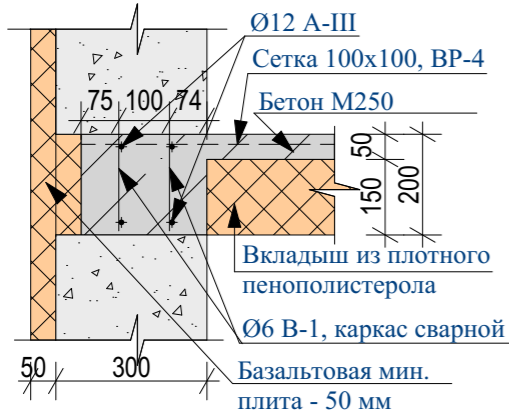
Узел опирания перекрытия на внешнюю стену
